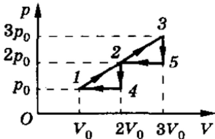
6. Определите КПД цикла, изображённого на рисунке. Рабочее тело – идеальный одноатомный газ.
