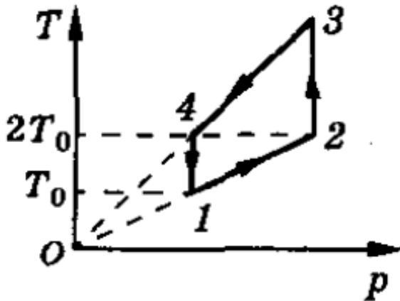
4. Над идеальным одноатомным газом произведён замкнутый процесс 1–2–3–1 (см. рисунок). Известно, что работа, совершаемая газом в этом процессе, в  $n = 9$  раз меньше количество теплоты, отдаваемого газом на участке 3–1. Чему равен КПД цикла?
